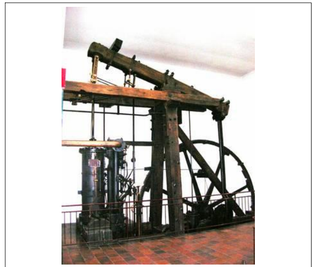
Dampfmaschine von James Watt, 1766 (Quelle: Deutsches Museum, München)
